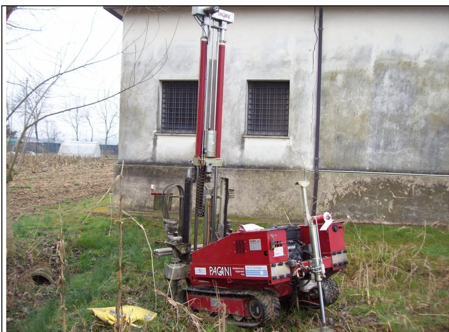
Foto 2: Esecuzione della prova CPT2
